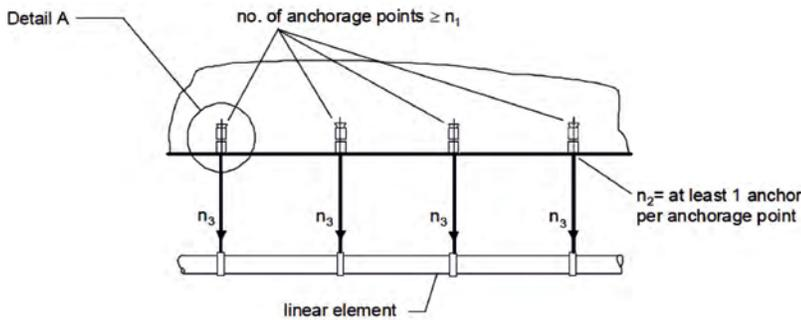
FIGURE 5—REDUNDANT FASTENING APPLICATION REQUIREMENTS FOR STRENGTH DESIGN OF TYPICAL FIXTURES
